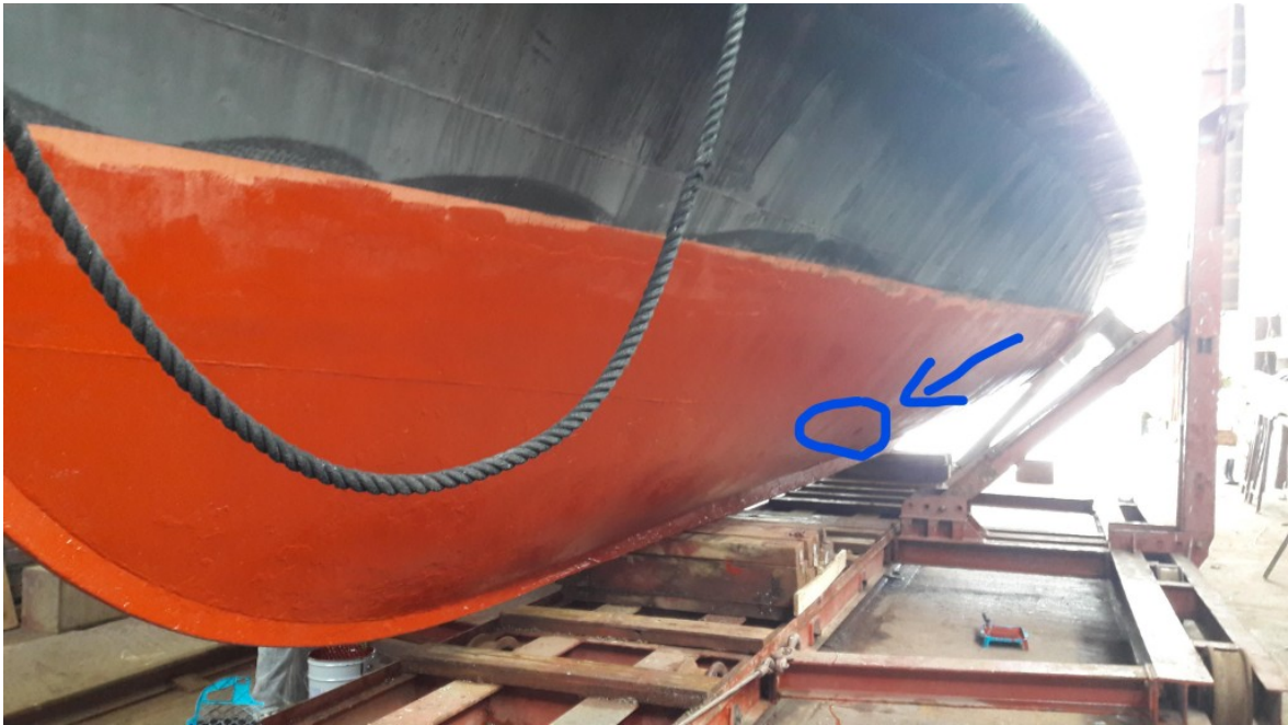
Einlauftiefe des Kühlwasserfilters bei 80cm © Sven Greve
