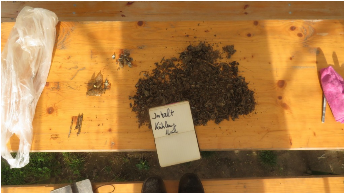
Ausgebreiteter Inhalt des Kühlwasserfilters. Der nasse Inhalt wurde an der Luft getrocknet. © Karl Walther
